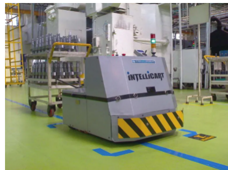
Exemplo de aplicação industrial de um robô seguidor de linha
