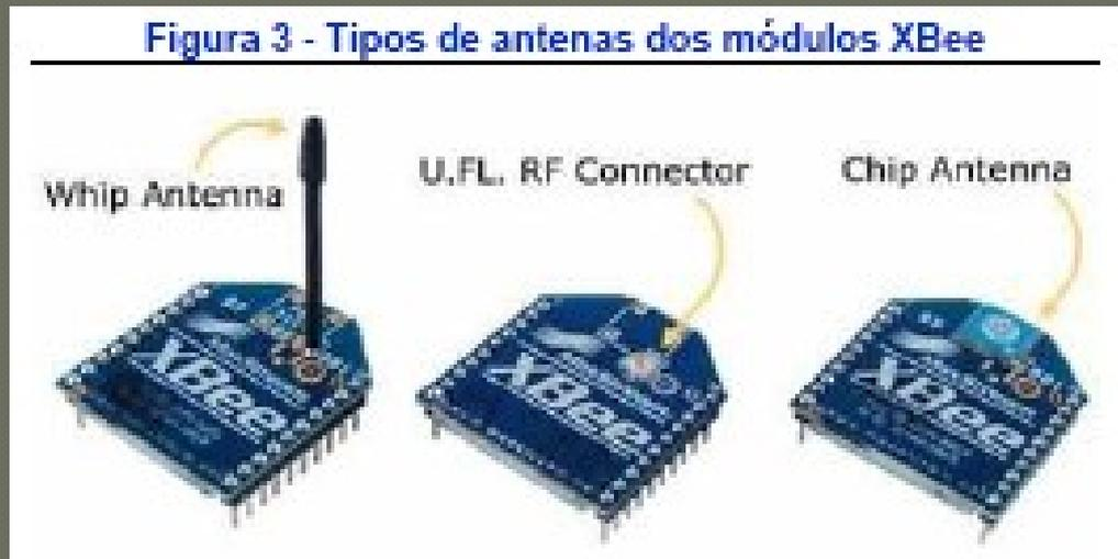
\* Entre os três tipos de antenas para os módulos XBee, as antenas **Whip** (~2,5cm), e a **Connector** (para antena externa) se destacam por poderem direcionar o feixe de sinal, melhorando a performance da rede, enquanto que a **Chip** destaca-se por ser muito mais compacta que as outras antenas.
