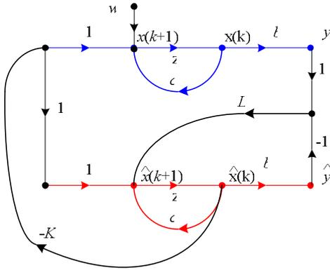
$$\begin{cases} \begin{bmatrix} x \\ \hat{x} \end{bmatrix}_{k+1} = \begin{bmatrix} c & -K \\ Lb & c - Lb - K \end{bmatrix} \begin{bmatrix} x \\ \hat{x} \end{bmatrix}_{k+1} + \begin{bmatrix} 1 \\ 0 \end{bmatrix} w(k) \\ y(k+1) = \begin{bmatrix} b & 0 \end{bmatrix} \begin{bmatrix} x \\ \hat{x} \end{bmatrix}_{k+1} \end{cases}$$
