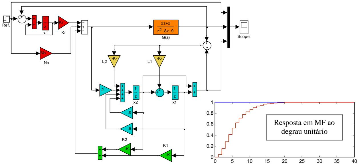
Obs: O fluxograma da prova indica realimentação positiva de  $x_i$  e se integra  $(r - y)$ , o que implica que os cálculos utilizando a equação  $|z\mathbf{I} - \phi + \Gamma K|$  fornecem  $u(k) = -K\mathbf{x}(k) = -\begin{bmatrix} -k_i & k_1 & k_2 \end{bmatrix} \mathbf{x}(k)$ .
