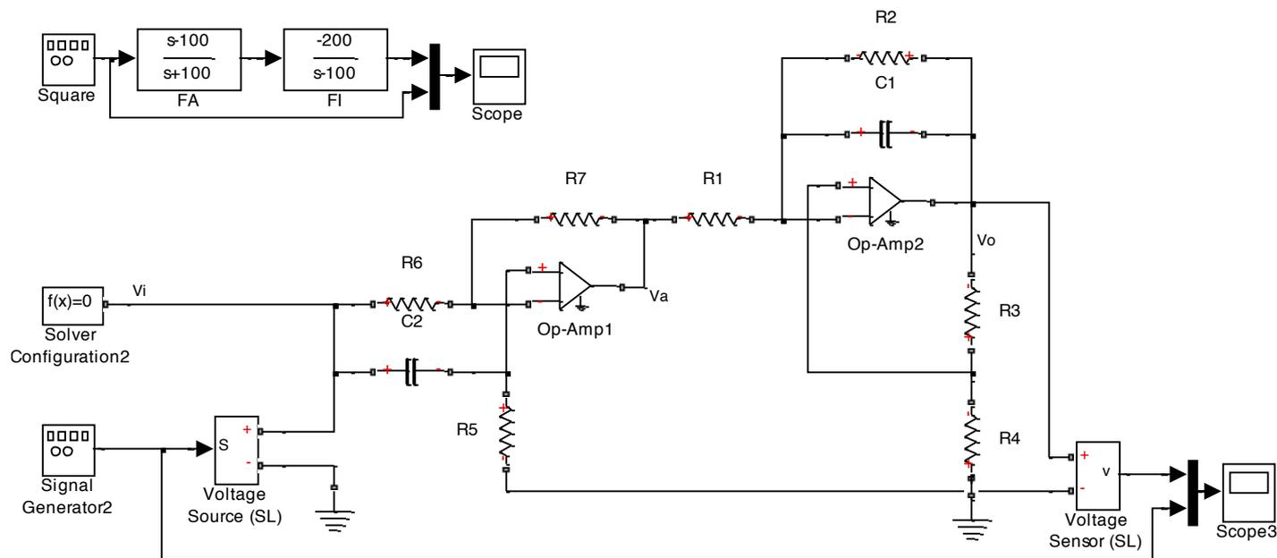
Considere o seguinte circuito, com  $C1=2 \mu\text{F}$ ;  $C2=1 \mu\text{F}$ ;  $R1=R2=R3=R5=R6=R7=10 \text{ k}\Omega$ ;  $R4=30 \text{ k}\Omega$ .
