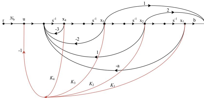
por inspeção (laços  $s^{-4}, s^{-3}, s^{-2}, s^{-1}$ ):  $K = [K_1 \ K_2 \ K_3 \ K_4] \quad \boxed{K = [1 - a \ 5 \ 4 \ 1]}$
