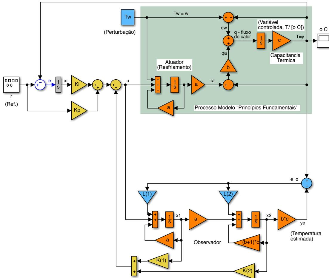
Para lidar com perturbações, erros de modelo (inclusive diferentes pontos de operação) e apresentar uma resposta rápida e sem oscilação, deve ser projetado nesta questão um controlador por realimentação de estados com canal PI.
