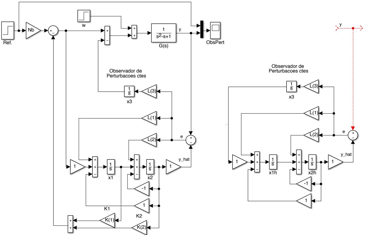
Para lidar com perturbações, erros de modelo e apresentar uma resposta rápida e sem oscilação, deve ser projetado nesta questão um controlador por realimentação de estados com observador de perturbações constantes.
