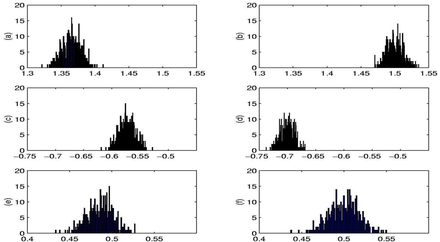
Figura 14: Eliminando polarização com o estimador MQT. Histogramas de valores estimados usando os estimadores MQ e MQT quando os sinais de entrada e saída têm ruído de medição branco. Os gráficos (a,c,e) correspondem ao estimador MQ e os gráficos (b,d,f) correspondem ao estimador MQT. Os valores reais
