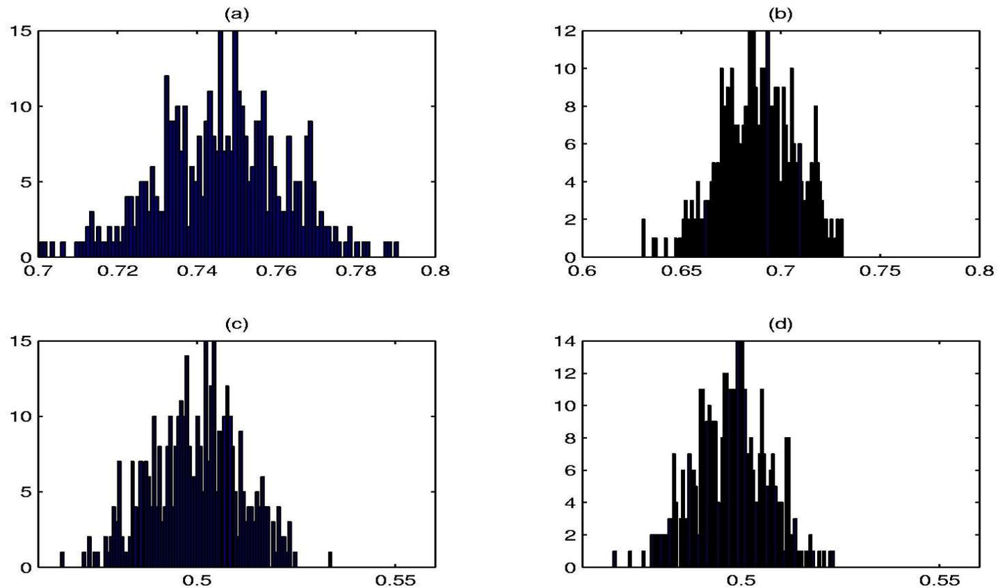
Figura 6: Estimador GMQ com ruído MA. Histogramas dos parâmetros estimados pelo estimador GMQ para o caso de erros do tipo ruído MA ( $e(k) = 0,8\nu(k-1) + \nu(k)$ ) e presença de regressores de saída. Os gráficos (a) e (c) correspondem aos valores dos parâmetros estimados na primeira iteração do algoritmo ite-
