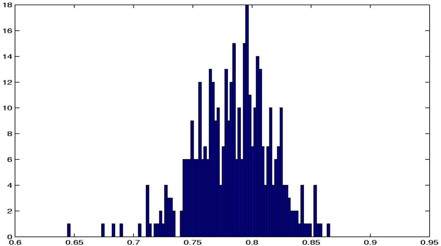
Figura 9: Estimador GMQ com ruído AR, coeficiente de ruído. Histograma de estimativas de  $-\hat{d}_1$ , sendo  $\hat{D}'(q) = 1 + \hat{d}_1 q^{-1}$ . O valor real de  $d_1$  é 0,8.
