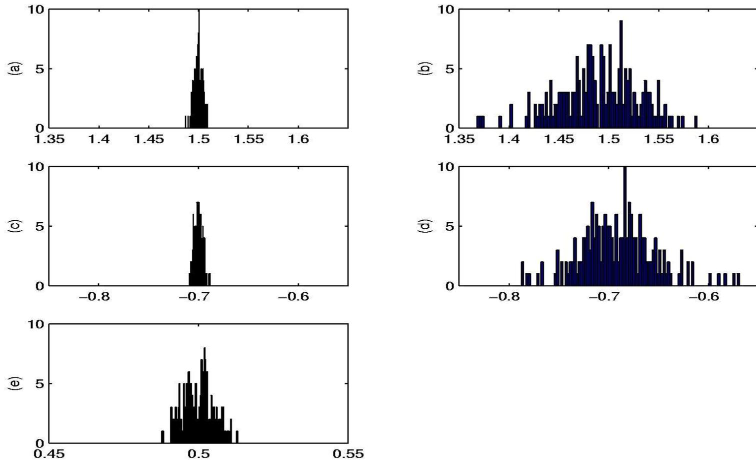
Figura 4: Estimador EMQ com modelo de erro na saída. Parâmetros estimados usando-se o estimador EMQ e um modelo ARMAX. Os dados foram gerados por um modelo de erro na saída. Os valores reais dos parâmetros são: (a,b)  $a_1 = c_1 = 1.5$ ;
