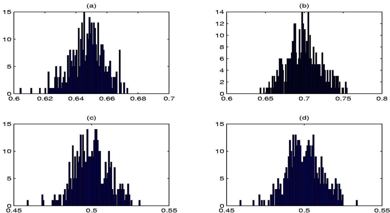
Figura 11: Estimador VI com ruído de observação. Histogramas dos parâmetros estimados pelo estimador VI para o caso de ruído de observação branco. Os gráficos (a) e (c) correspondem aos valores dos parâmetros estimados pelo estimador MQ. Os gráficos (b) e (d) correspondem ao estimador VI com
