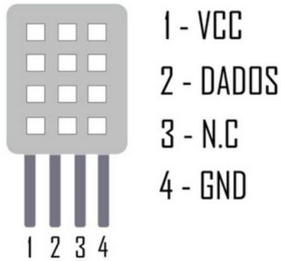
Figura 5.8: Pinagem do DHT22 [3].
