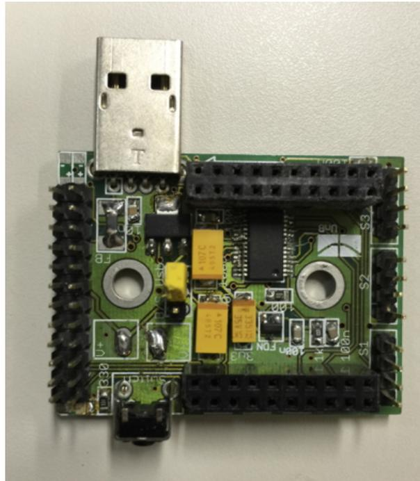
Figura 5.5: Placa ZigBit Channel 1.0, LARA/UnB, usada como Gravadora/Coordenadora.
