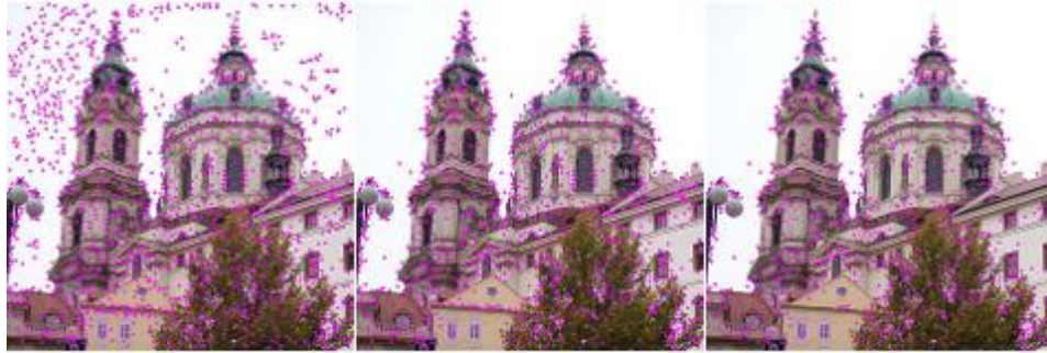
Figura 2.8 – Pontos registrados nos 3 passos. A primeira imagem registra os pontos após a aplicação da diferença de gaussianas. A segunda imagem mostra os keypoints após a rejeição de pontos de baixo contraste. A terceira imagem mostra os pontos restantes após a retirada daqueles localizados em bordas instáveis. (Fonte: [16])
