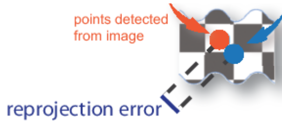
Figura 2.13 A imagem acima mostra graficamente o que é o erro de reprojeção. (Fonte: Camera Calibration Toolbox – MATLAB)
