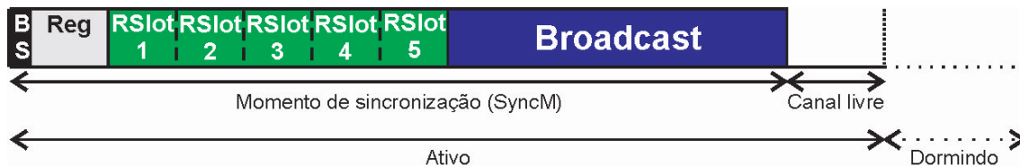
Figura 3.6- Diagrama do período de sincronização (SyncM) do DyTEE. [2]
