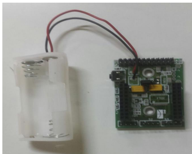
Figura 4.4- Placa ZigBit Channel 1.0 com funcionalidade dispositivo final.
