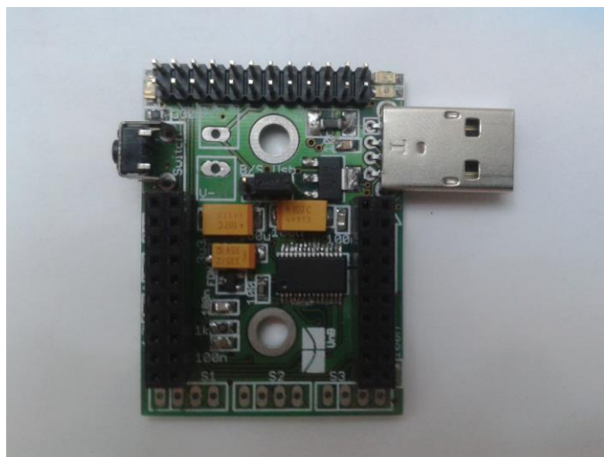
Figura 4.3 – placa ZigBit Channel 1.0 que exerce a função de Coordenador/Gravadora.
