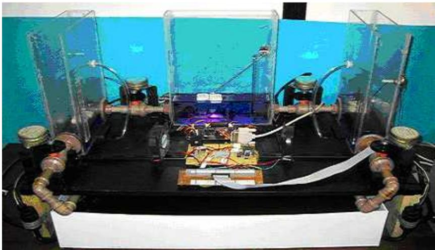
Figura 1 – Sistema de Tanques Acoplados [3]
