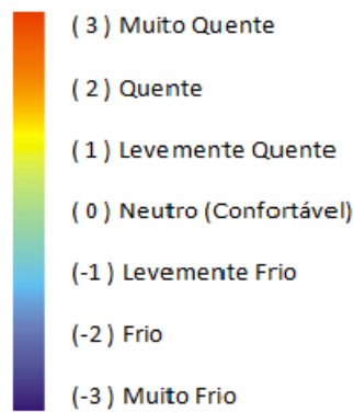
Figura 2.3 - Índice PMV relacionado ao nível de conforto térmico.
