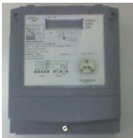
Figura 7.2. Medidor de energia trifásico
