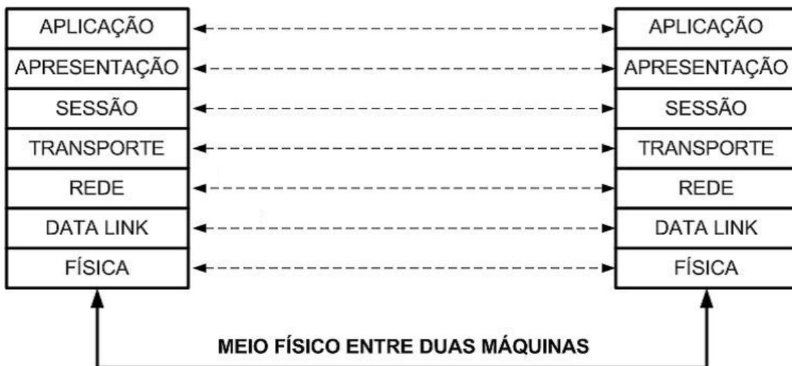
Figura 5.1. Modelo ISO OSI com adaptação, [8].
