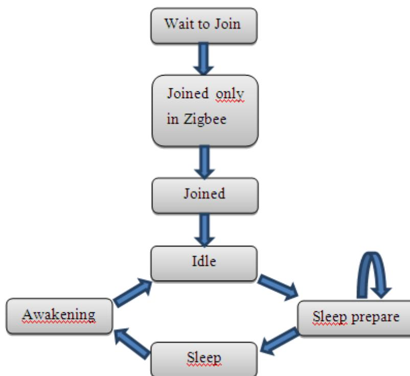
Figura 6.18. Máquina de estados do end device.
