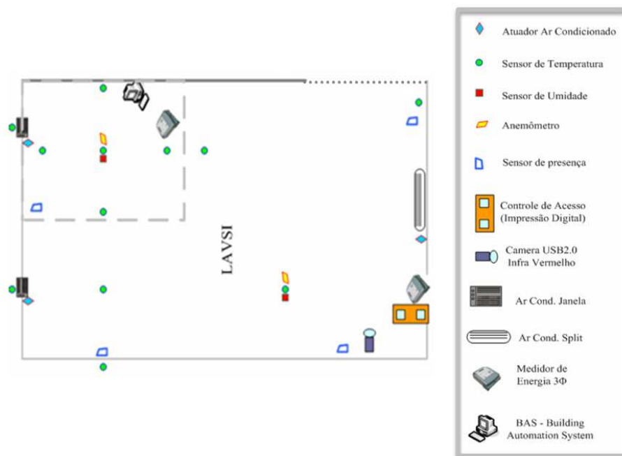
Figura 5.2 – Disposição dos equipamentos na planta piloto [4].
