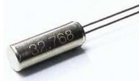
Figura 3.27. Cristal de quartzo usado em sistemas RTC.
