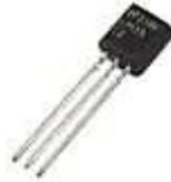
Figura 3.29. Circuito integrado LM35.
