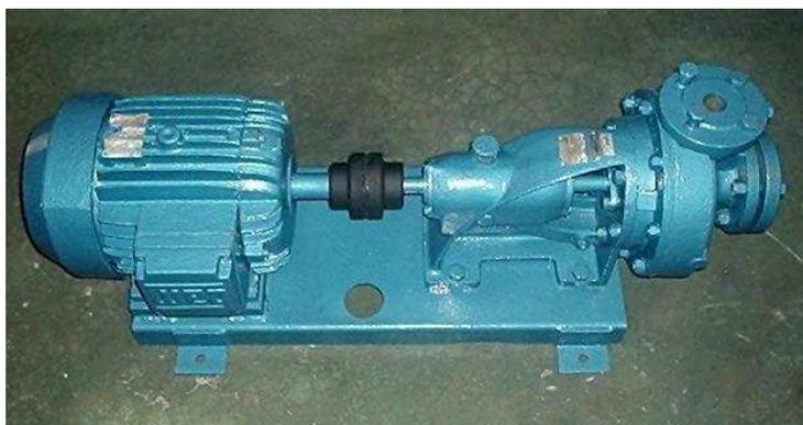
(a) Motor elétrico acoplado ao rotor.
