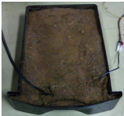
Figura 3.41. Recipiente para teste de umidade.
