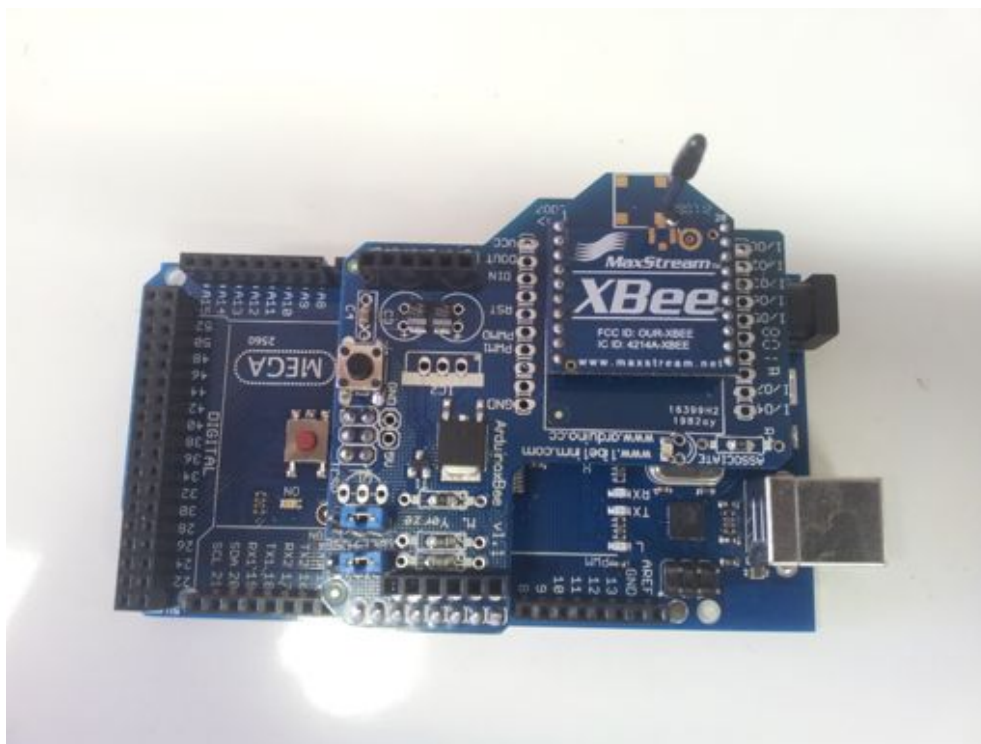
Figura 5.3: Arduino MEGA montado com shield X-Bee.
