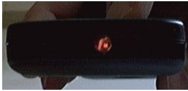
Figura 2.11: Transmissor IR aceso visto por uma câmera.
