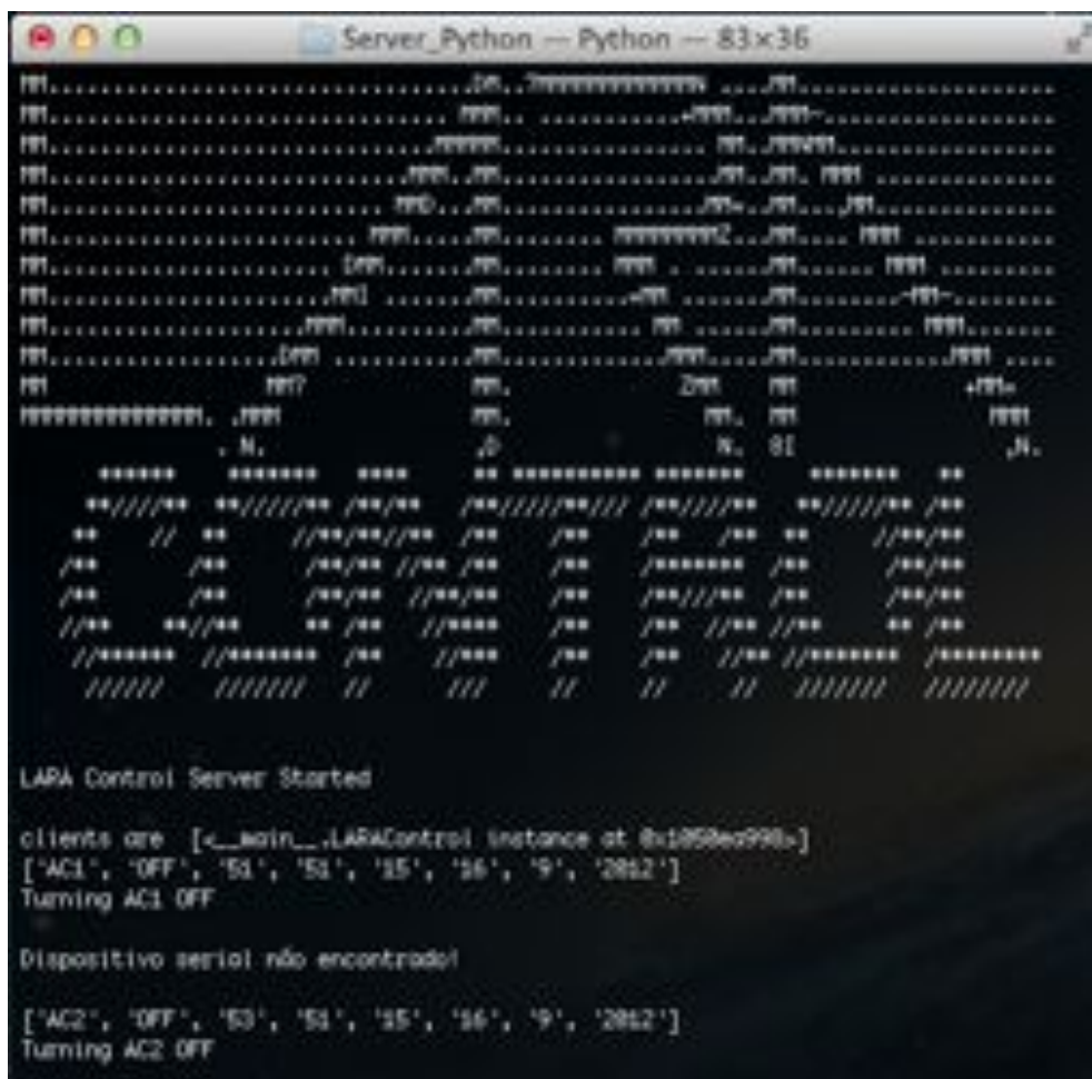
Figura 6.2: Servidor mostrando erro ao tentar enviar mensagem via serial.
