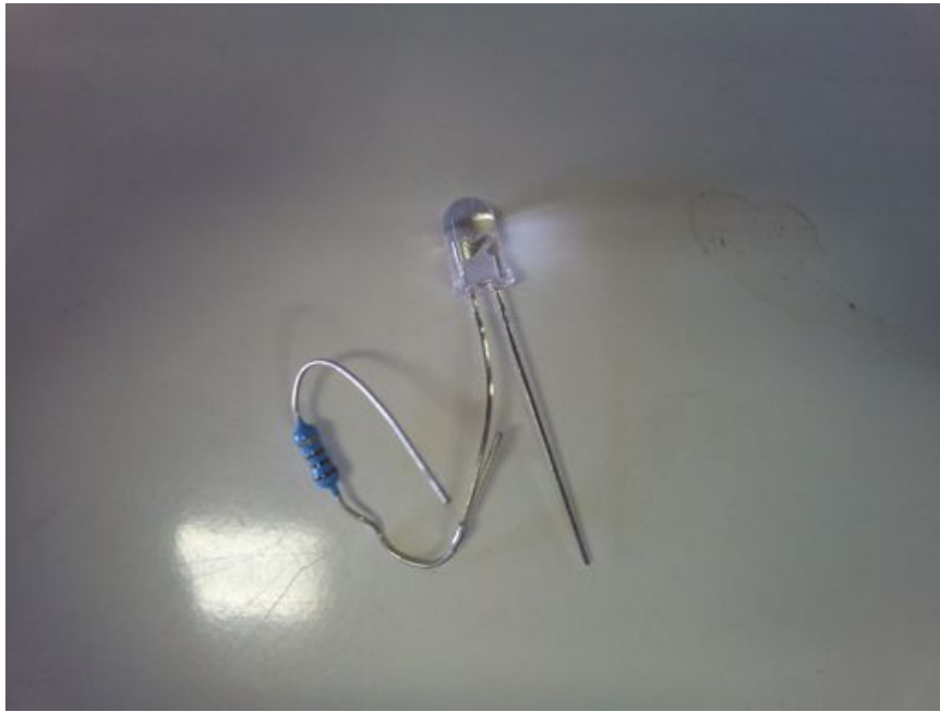
Figura 5.9: Solda feita do LED IR com o resistor de 100 ohms.
