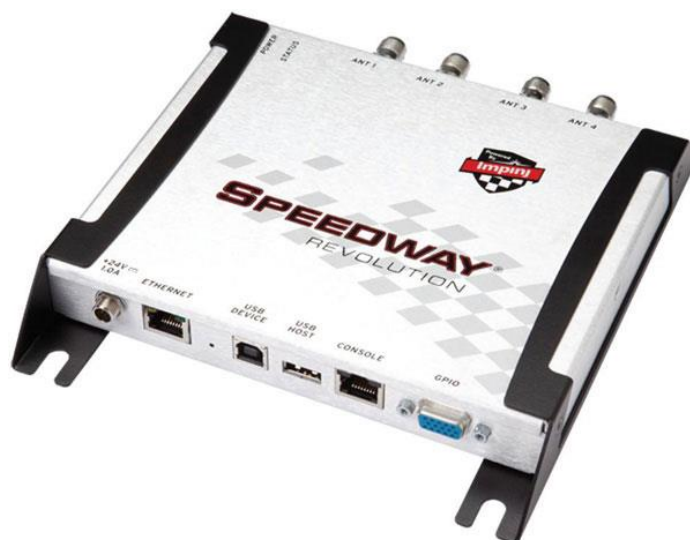
Figura 4-3 Leitora RFID Impinj Speedway R420, [9].
