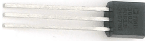
Figura 4-12 LM35: sensor de temperatura, [15].
