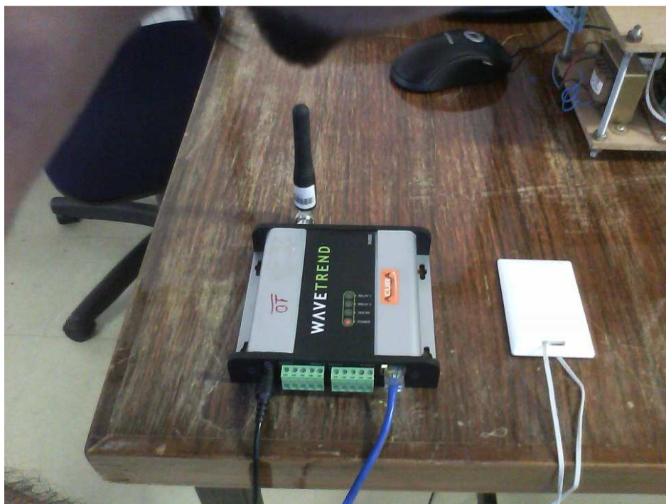
Figura 14. Figura que mostra a leitora e a tag em cima da mesa da sala de reuniões do LARA. Foto mostra o cabo UTP que conecta a leitora à rede TCP/IP do LARA. A tag possui uma cavidade para que se utilize um fio a fim de portá-la como um crachá.
