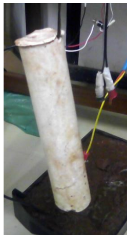
Figura 3.38. Sensor de umidade do tipo eletrodos em bloco de gesso (20cm de comprimento, 5cm de diâmetro).
