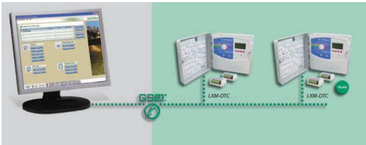
Figura 2.7. Exemplo de sistema Rain Bird de controle a distância por diferentes vias de comunicação.
