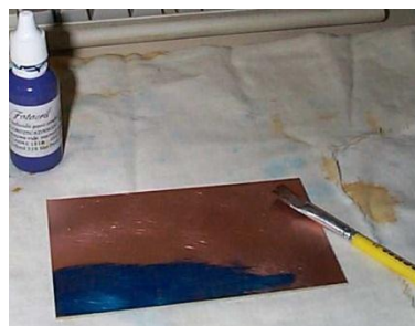
(b) Placa virgem coberta de resina em fotossensível.
