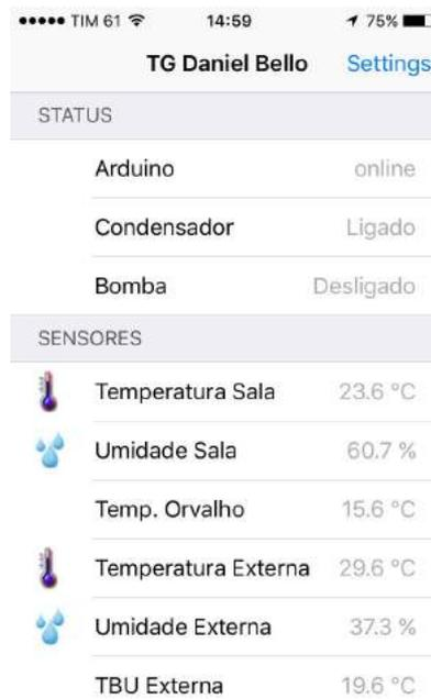
Figura 39. Interface para telefone celular do openHAB mostrando situação em que a TBU Externa está maior do que 19,5 e a temperatura interna está maior que 23,6. Nesse caso, o sistema convencional é ligado e o evaporativo, desligado.
