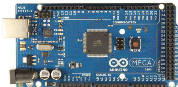
Figura 19. Arduino Mega 2560
