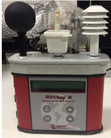
Figura 16. Estação de monitoramento de temperatura e umidade 3M Quest Temp<sup>o</sup> 36<sup>o</sup>.
