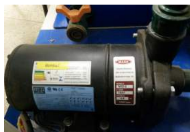
Figura 2.3: Bomba e motor elétrico
