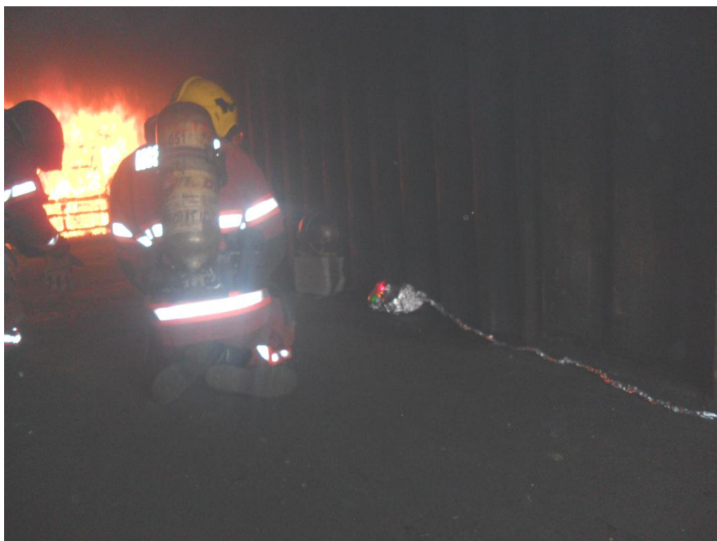
Figura 5.8. As luzes do primeiro painel acendendo conforme o aumento de temperatura.
