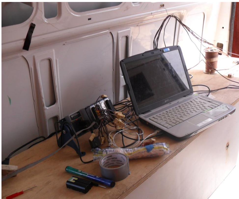
Figura 5.6. Instalação dos módulos NI e conexão com o computador.
