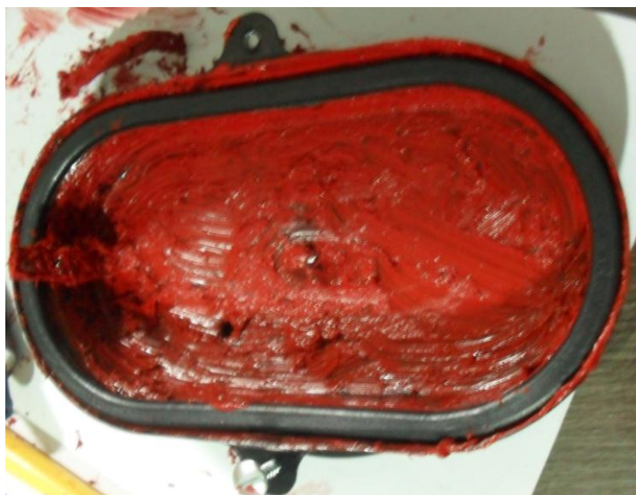
Figura 4.17. Silicone para alta temperaturas aplicado na luminária.
