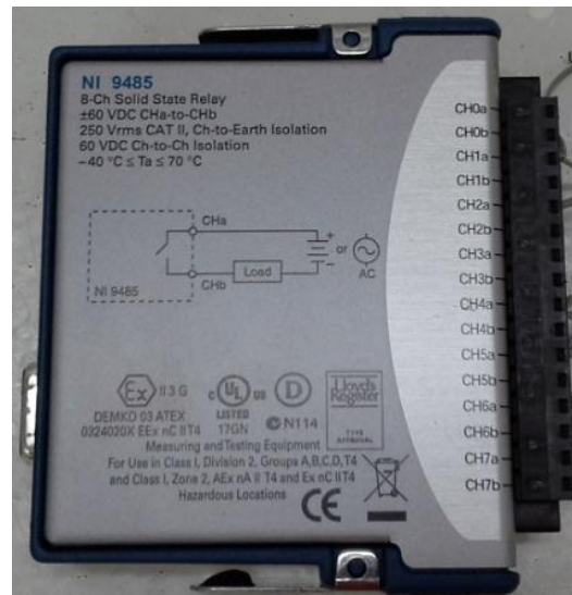
Figura 4.23. Módulo NI 9485 – Relay para ligar e desligar os LEDs.
