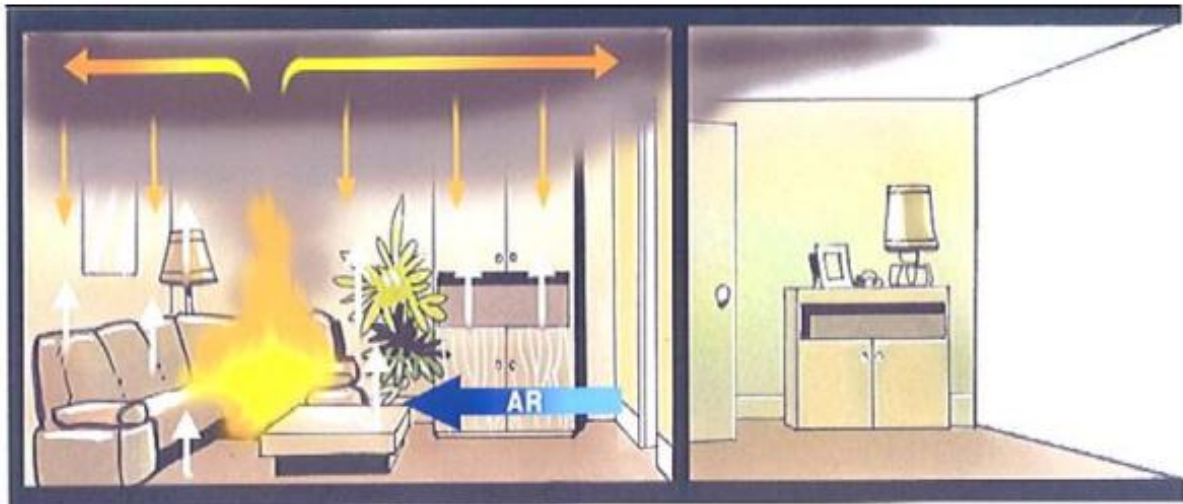
Figura 3.8. Ilustração da dinâmica da fumaça em um incêndio em local confinado. Fonte: Le guide national de référence Explosion de Fumées – Embrassement Généralisé Éclair.
