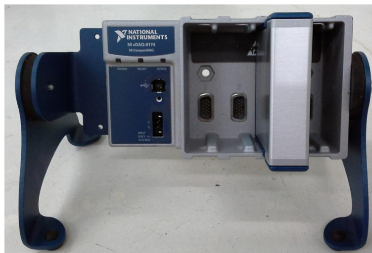
Figura 4.24. Base NI cDAQ-9174 – Sincroniza os módulos ao computador.
