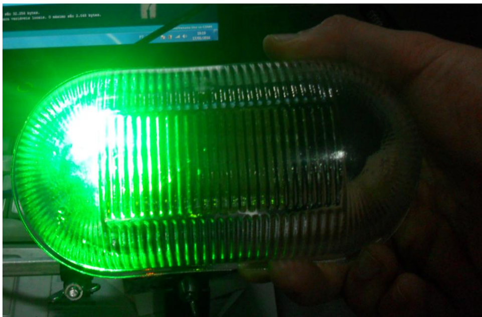
Figura 3.2. Painel de três canais com as cores verde, amarelo e vermelho.
