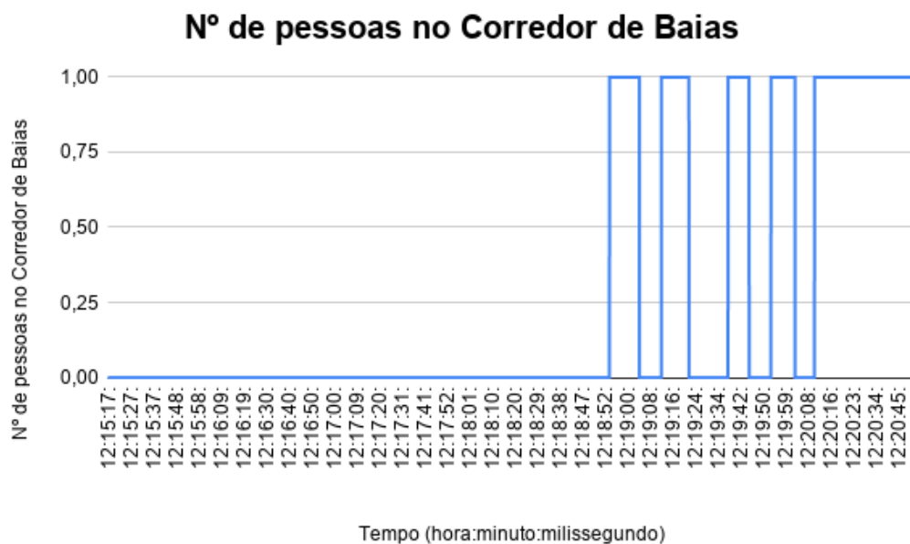
Figura 4.69: Passagem a 30 cm de distância da antena com a tag orientada perpendicularmente à antena.
