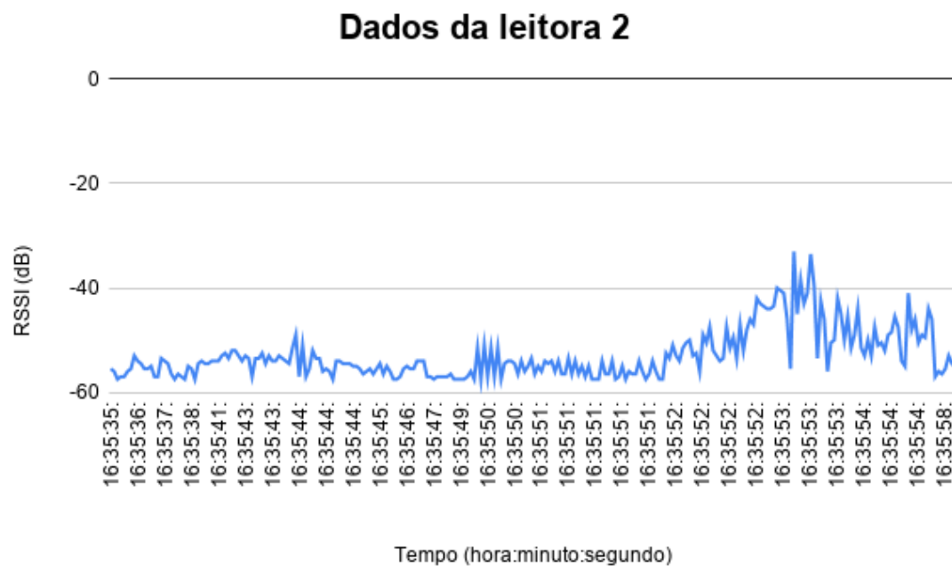
Figura 4.53: Leitura RSSI para passagem de 5 tags simultaneamente.
