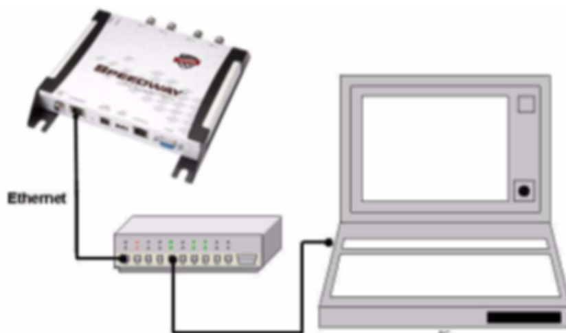
Figura II.10: Exemplo de rede configuração de rede utilizando cabo ethernet e switch de rede. Imagem retirada de [3].
