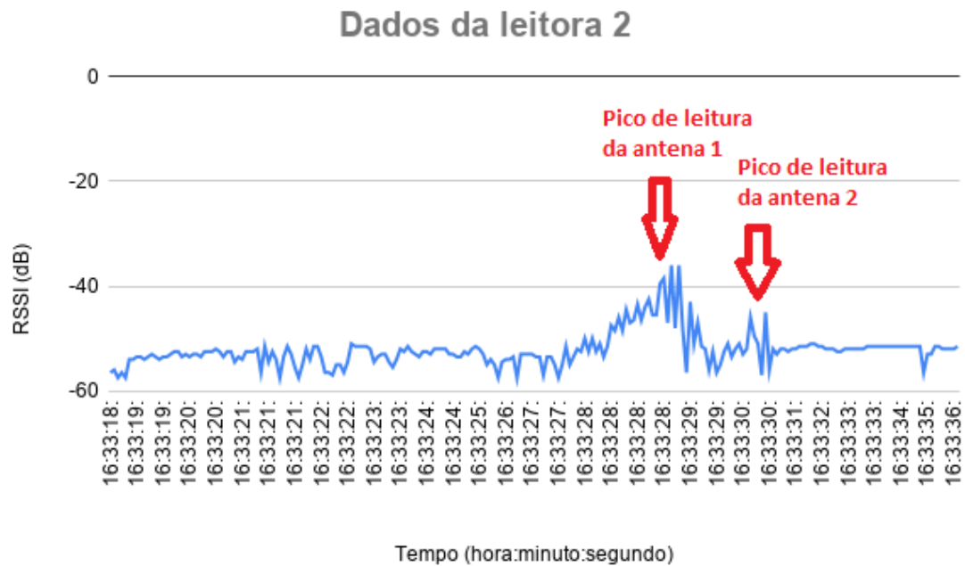
Figura 4.41: Leitura RSSI para passagem de 2 tags simultaneamente.
