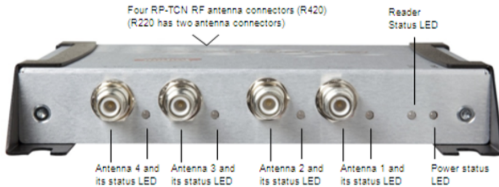
Figura 3.4: Portas da antena no Reader Speedway R420. Imagem retirada de [3].
