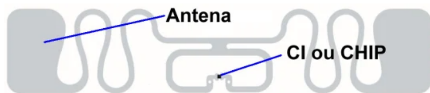
Figura 2.5: Componentes básicos de uma tag. Fonte: https://rfidmoura.wordpress.com/
