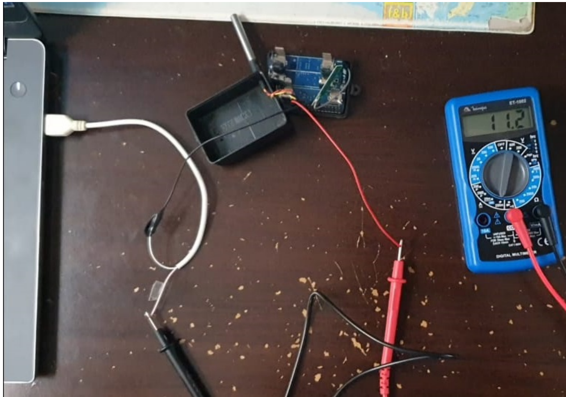
Figura 5.14: Medição de corrente do dispositivo sem a utilização do modo de baixo consumo. A escala do amperímetro se encontra em 200mA.
