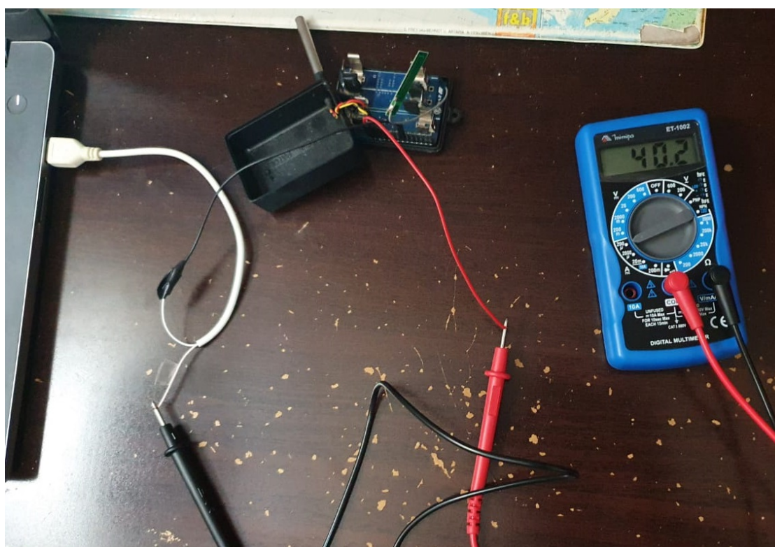
Figura 5.13: Medição de corrente do dispositivo em modo de baixo consumo. A escala do amperímetro se encontra em 200\mu A .
