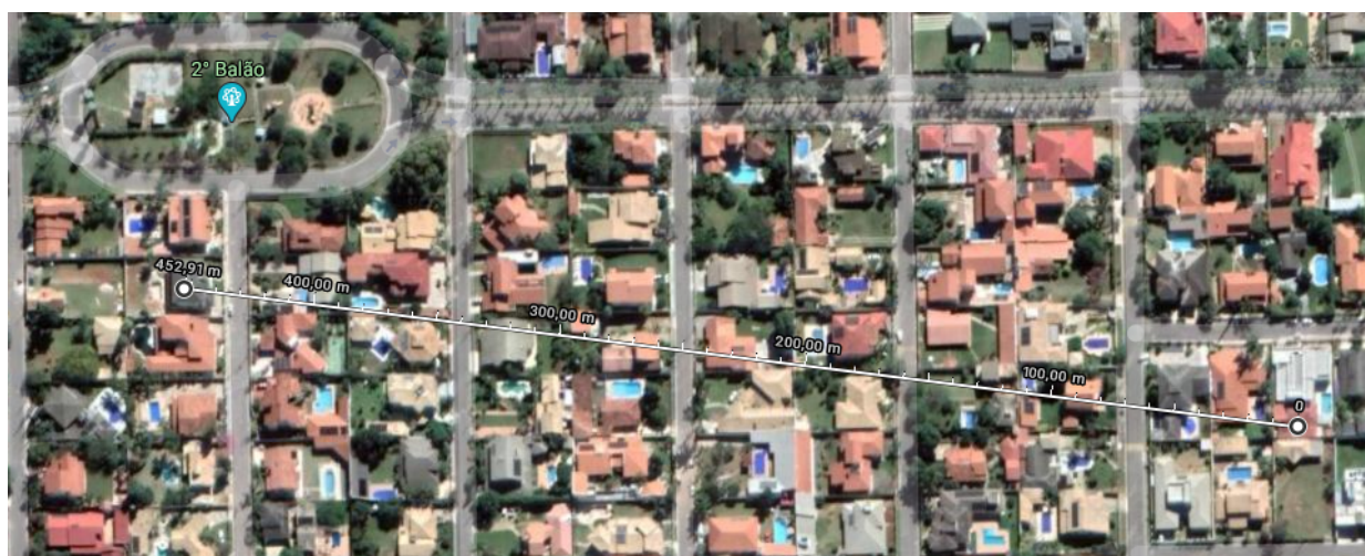
Figura 5.18: Teste de distância, aonde o dispositivo e o gateway se encontram nos pontos marcados no mapa a uma distância de aproximadamente 450m.
