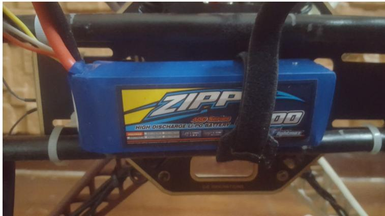
Figura 4.3: Foto da bateria escolhida na estrutura
