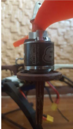
Figura 4.2: Foto do motor montado na estrutura
