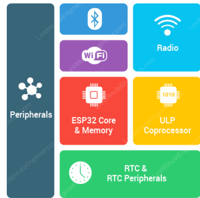
Figura 3. Diagrama dos blocos funcionais do chip ESP32 que podem ser desligados seletivamente para reduzir o consumo de energia.
