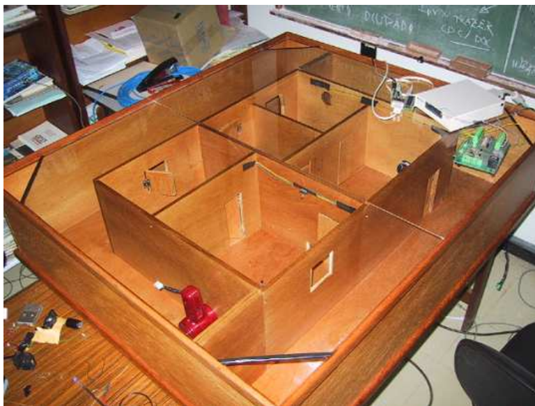
Figura 5.1- Maquete de automação predial em madeira.
