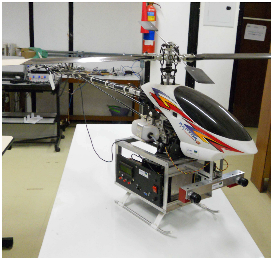
Figura 1.4: VANT e câmeras a serem utilizados no processo de inspeção.
