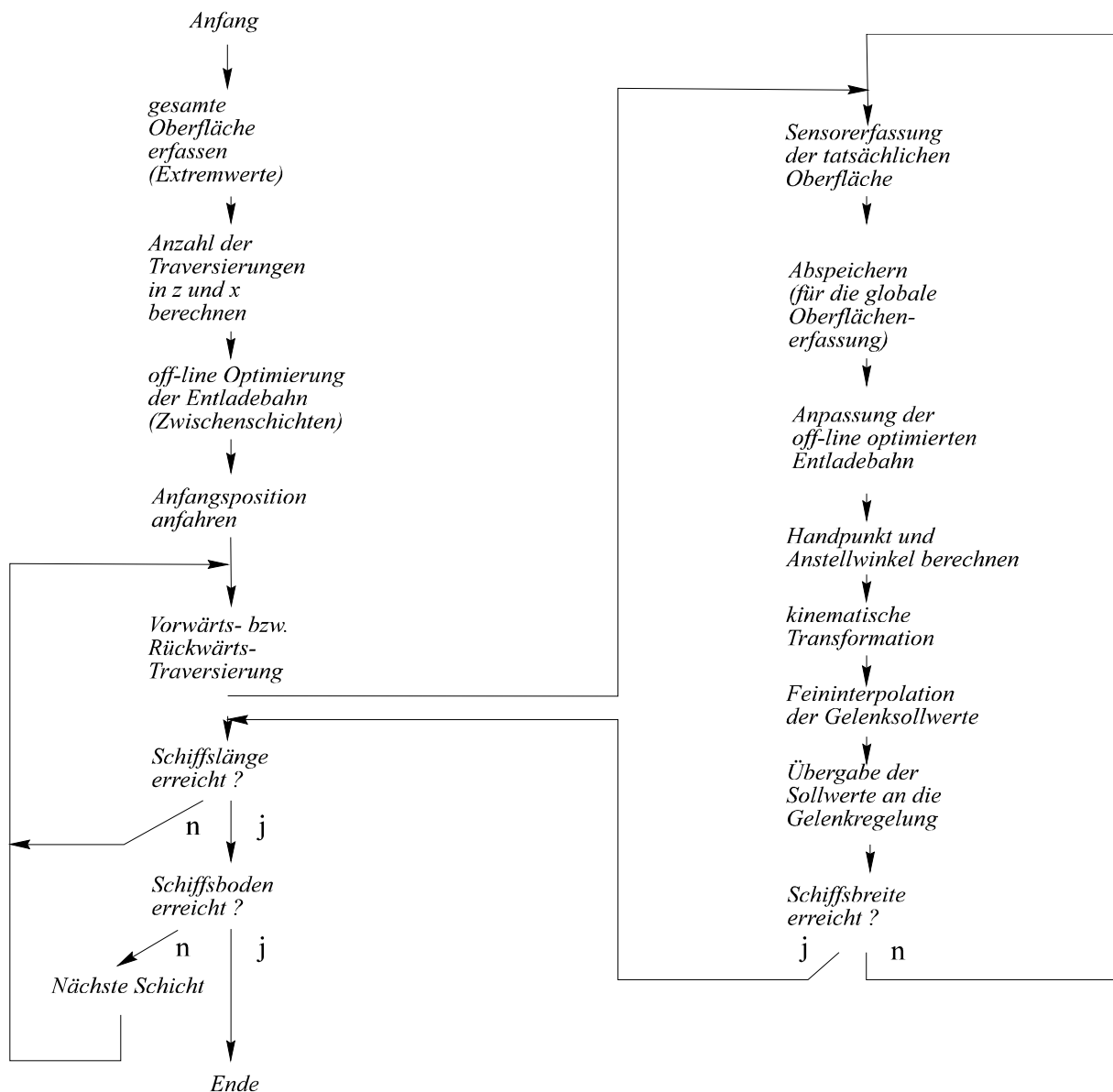
Bild 4.26 Flußdiagramm zur Realisierung der Führungsgrößenerzeugung.
