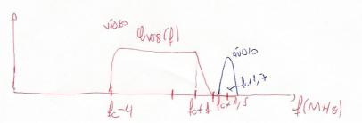
Um sinal de frequência  $f_c + \Delta f$  ao ser multiplicado pelo sinal do oscilador local com frequência  $f_c + f_i$  e filtrado com um filtra passa-faixa em  $f_i$  resulta em
