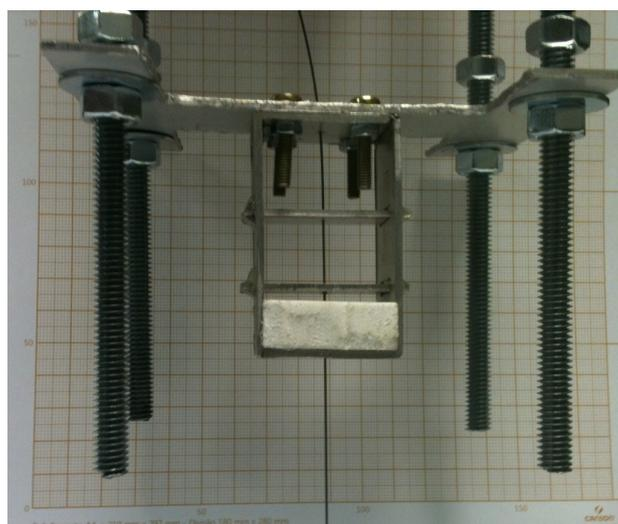
Figura 4.3: Ajuste fino da posição da armação metálica do dispositivo de inserção por micropasso
