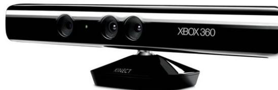
Figura V.1: Sensor Kinect utilizado para rastrear a posição da mão do operador
