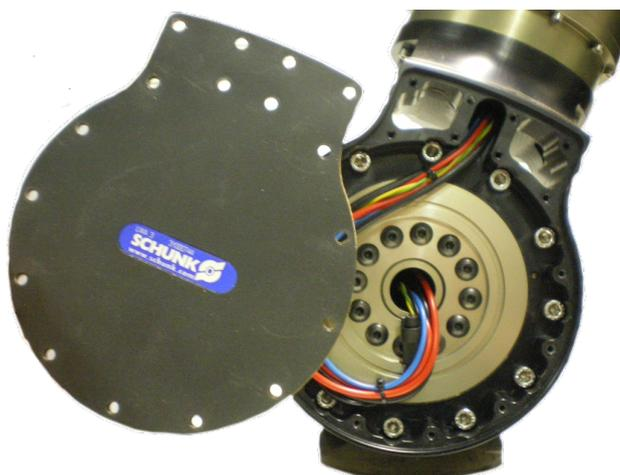
Figura III.5: Tampa removível no elemento de conexão, que permite acesso direto ao módulo PRL
