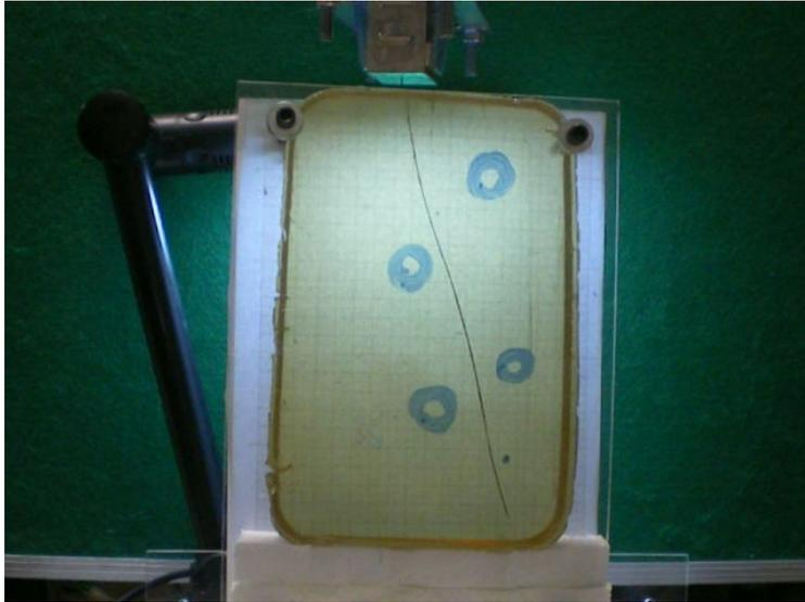
Figura 4.6: Inserção desviando de obstáculos, alternando-se entre micropassos e rotações de  $180^\circ$
