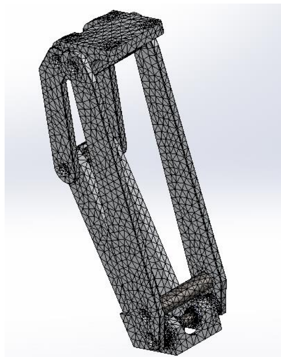
Figura 76: Malha para a simulação do Joelho.
