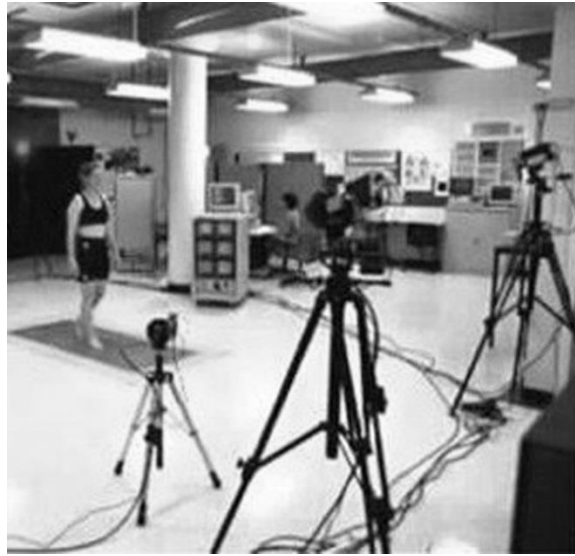
Figura 30: Exemplo de teste com videogrametria. Adaptado de [25]
