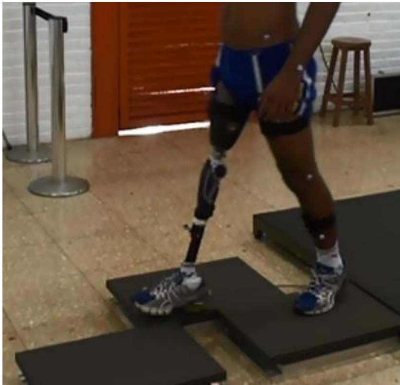
Figura 32: Utilização de plataformas de forças em testes de dinamometria.
