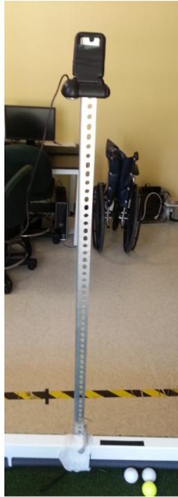
Figura 3.3: Câmera secundária fixada ao suporte ligado à plataforma
