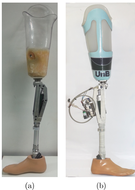
Figura 3.1: Protótipo em dois momentos: (a) montado e com o atuador acoplado, ainda com soquete provisório; (b) protótipo funcional, com sistema embarcado e sensores acoplados.
