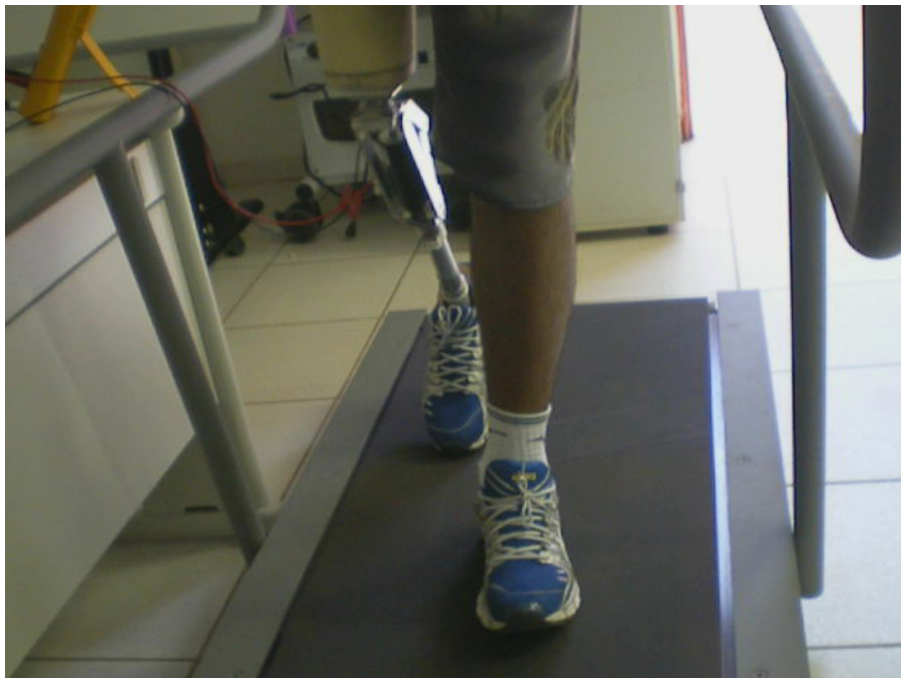
Figura 4.2: Voluntário caminhando em uma esteira com a prótese em modo controle manual.
