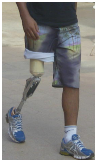
Figura 4.1: Fotografia de voluntário amputado caminhando com a prótese em modo passivo.
