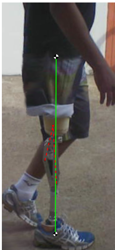
Figura 3.14: Foto de um indivíduo com amputação transfemural utilizando o protótipo. Destaque para o posicionamento da linha de carga (em verde) em relação ao centro instantâneo de rotação (ponto de encontro entre as linhas pontilhadas em vermelho).
