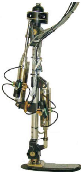
Figura 2.20: Fotografia de prótese transfemural robótica atuada por pistões pneumáticos. Fonte: [57].
