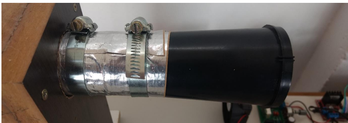
Figura 2.15. Suporte para conexão da elétrica e motor DC no tubo metálico.
