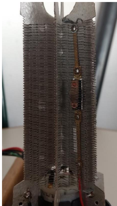
Figura 2.13. Mecanismo eletromecânico de proteção.
