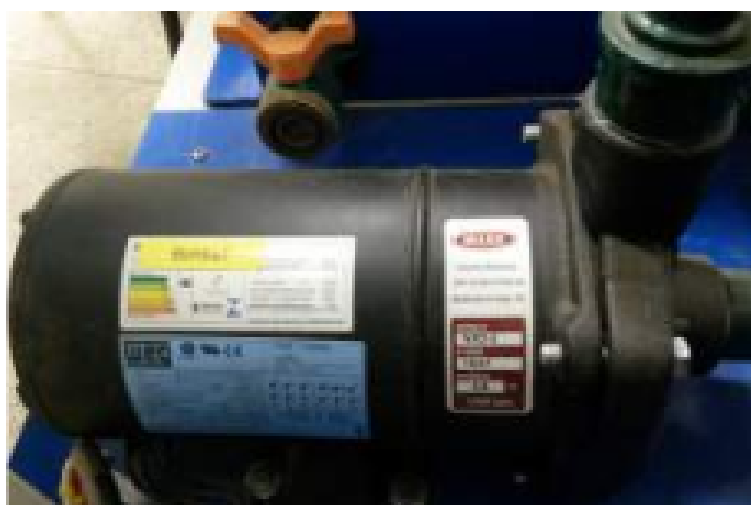
Figura 7 – Bomba GRUNDFOS e Motor WEG acoplados (TAVARES; OLIVEIRA, 2015).
