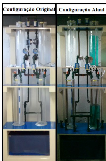
Figura 9 – Alterações no Acoplamento de Tanques.
