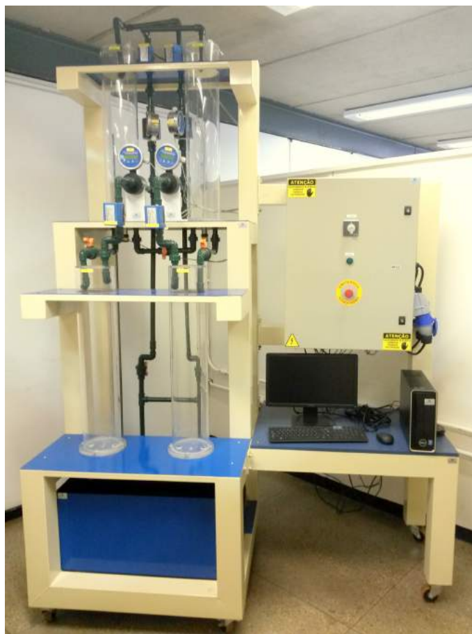
Figura 2.1: Planta Piloto Industrial de Tanques Quádruplos
