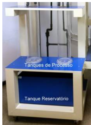
Figura 2.6: Tanques Reservatório e de Processo
