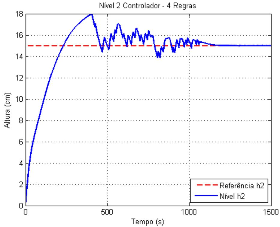
Figure 7.31: Nível H2 Controlado - Com *Anti-Windup*
