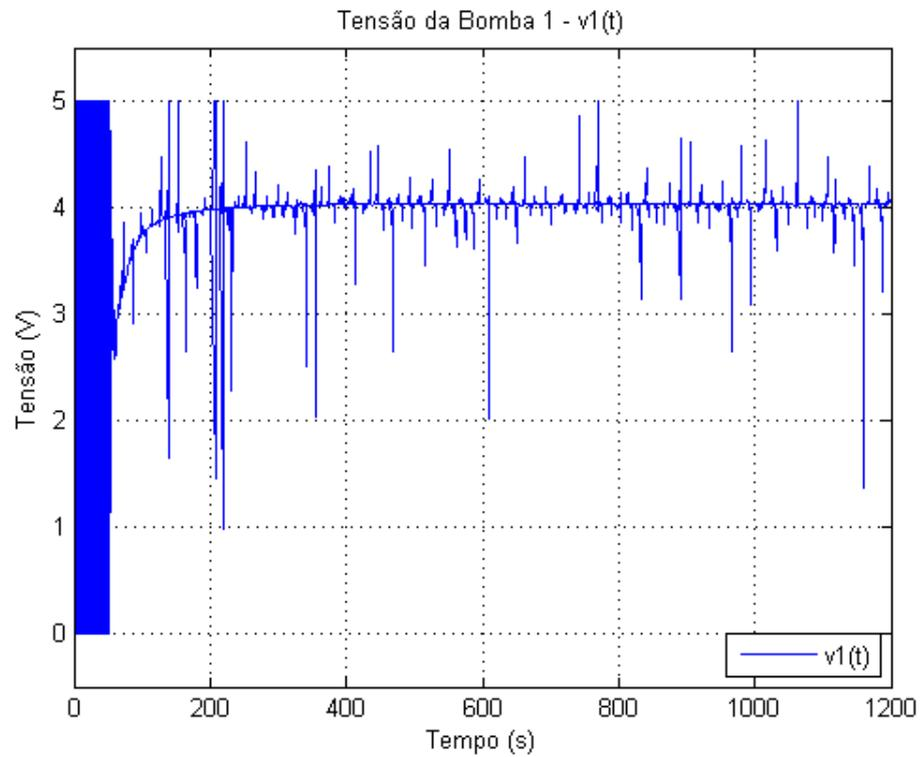
Figure 7.16: Sinal de saída do controlador - v1
