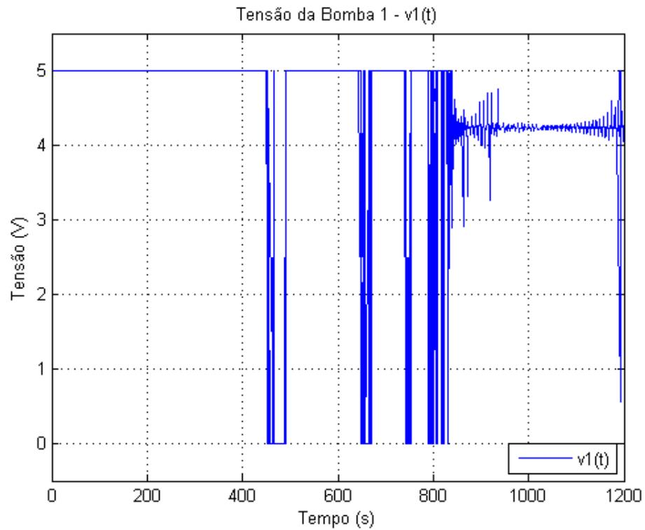
Figure 7.28: Sinal de saída do controlador - v1
