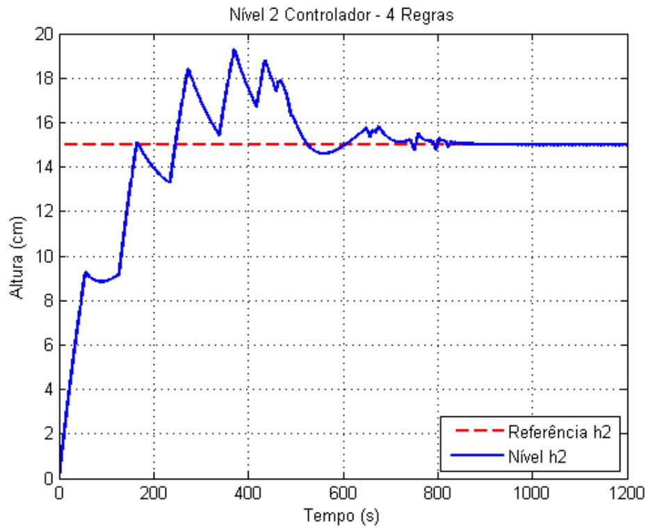
Figure 7.27: Nível H2 Controlado - Com saturação do Controlador
