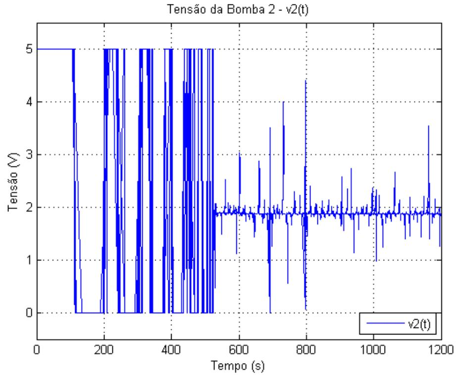
Figure 7.13: Sinal de saída do controlador -  $v_2$
