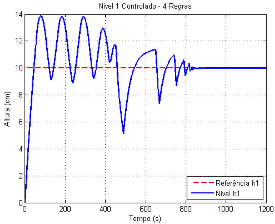
Figure 7.26: Nível H1 Controlado - Com saturação do Controlador
