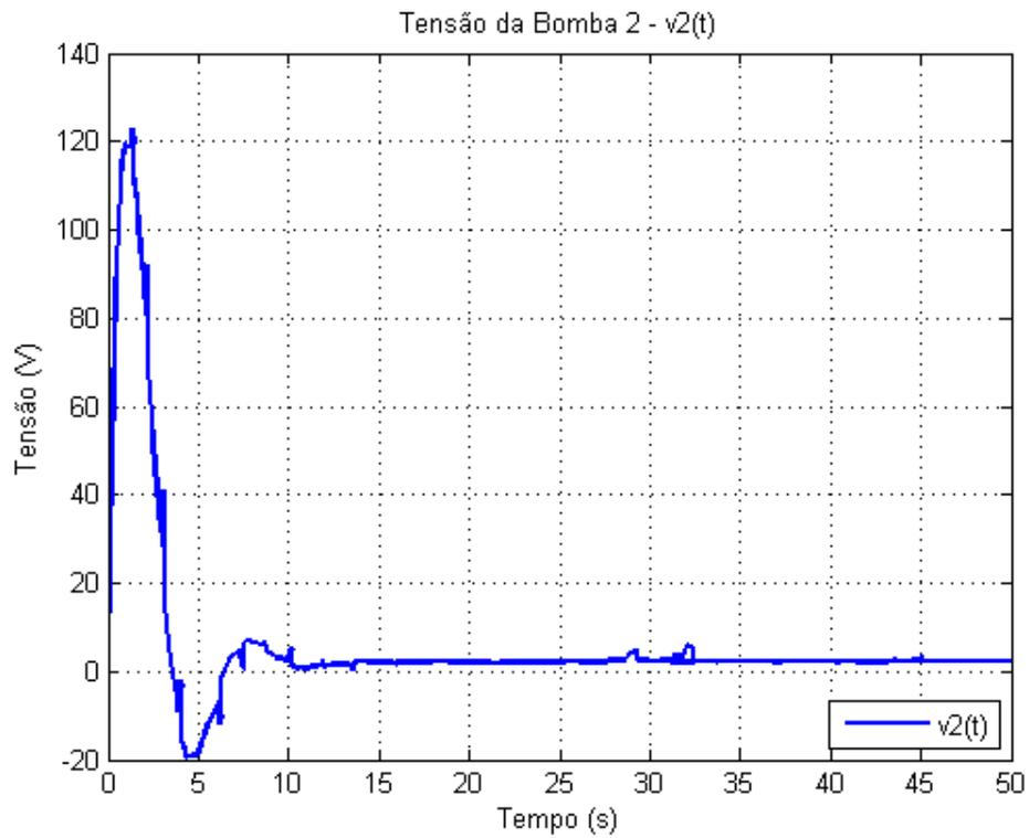
Figure 7.9: Sinal de saída do controlador -  $v_2$
