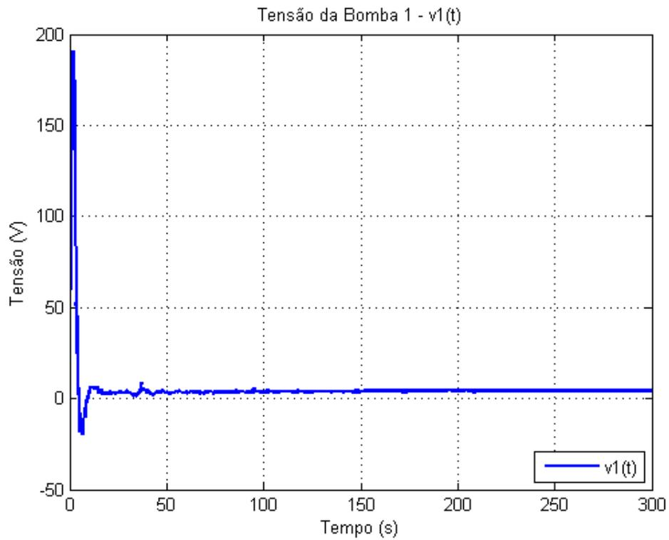
Figure 7.24: Sinal de saída do controlador -  $v_1$
