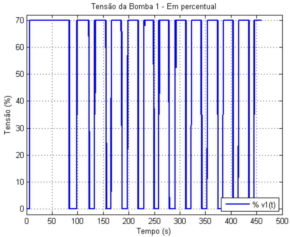
Figure 7.36: Sinal de saída do controlador - v1
