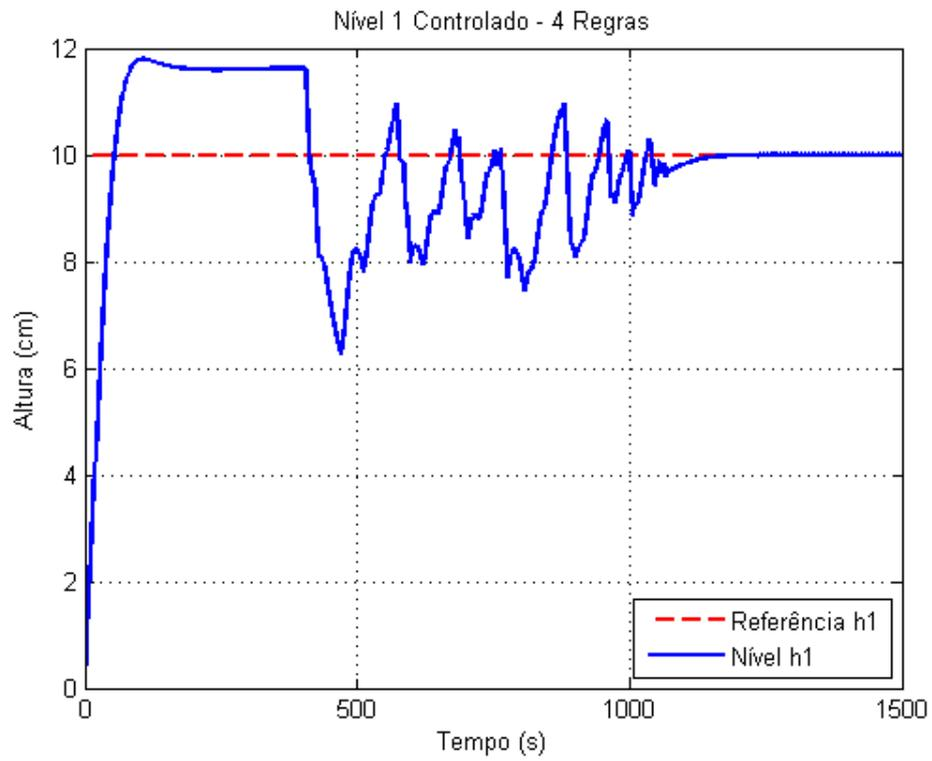
Figure 7.30: Nível H1 Controlado - Com *Anti-Windup*
