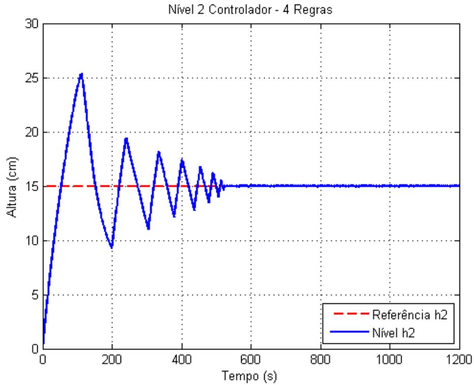
Figure 7.11: Nível H2 Controlado - Com saturação do Controlador
