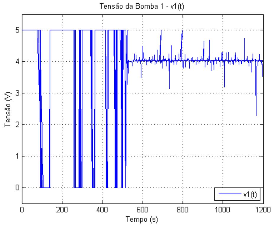
Figure 7.12: Sinal de saída do controlador -  $v_1$
