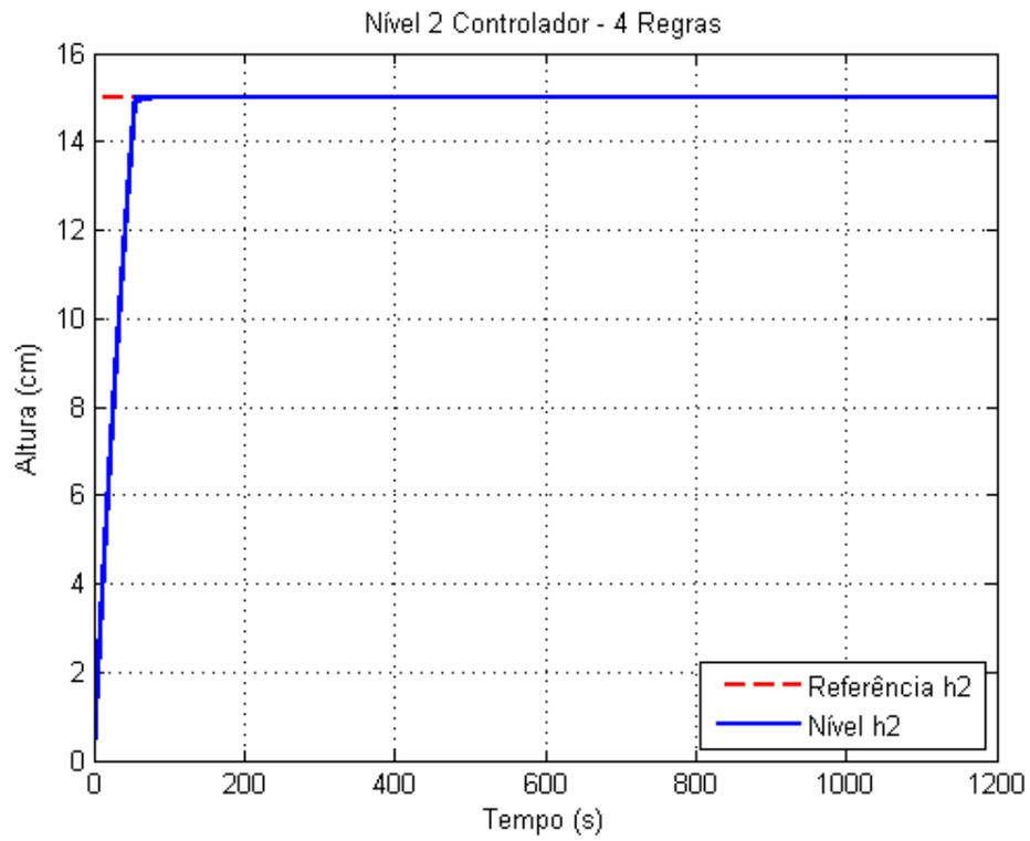
Figure 7.15: Nível H2 Controlado - Com *Anti-Windup*
