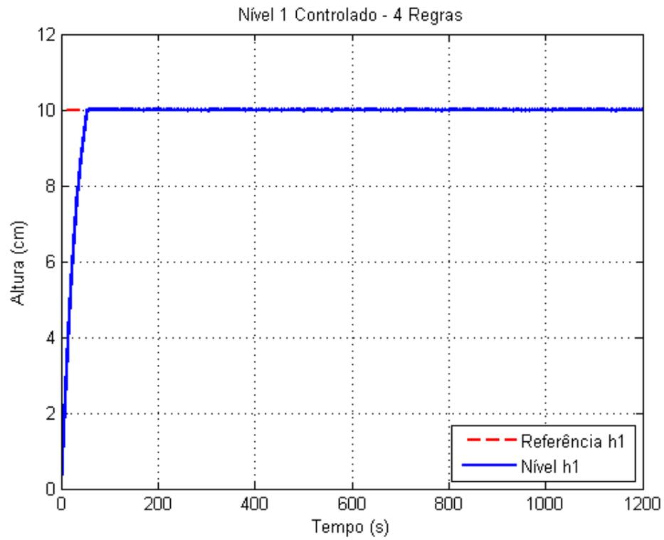
Figure 7.14: Nível H1 Controlado - Com *Anti-Windup*
