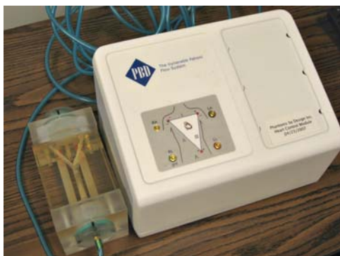
Figura 1: Phantom de escoamento pulsátil ( Phantoms by Design, Inc., Bothell, WA ) usado para validar o método proposto.
