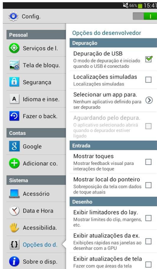
Figura 4.5: Ativação da depuração via cabo USB no Tablet.
