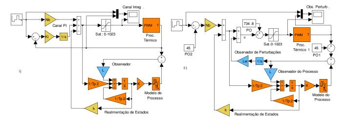
O processo térmico, conforme obtido no experimento 2 de CDig, tem o seguinte modelo:
