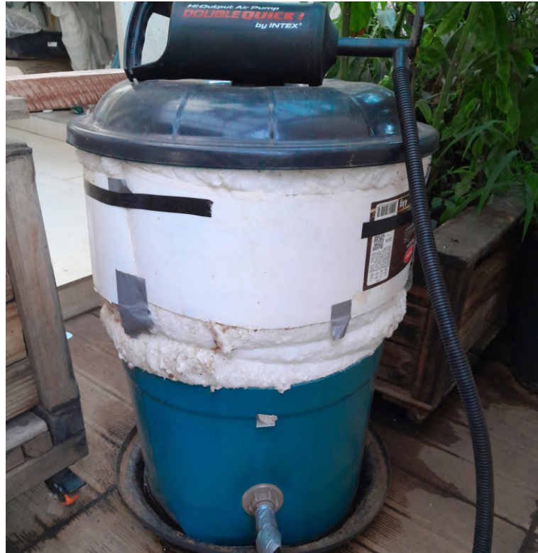
Figura 3.44 – Biorreator B, Balde de 60L isolado com fibra cerâmica
