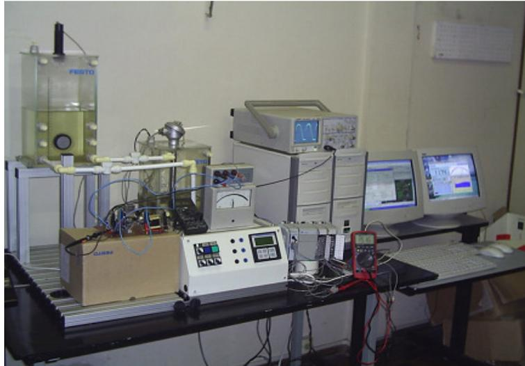
Figura 1.4 – Sistema didático para controle de nível e temperatura do CEFET-RS.
