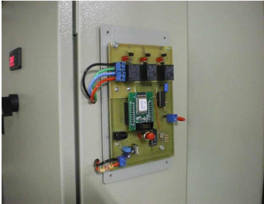
Figura 4.1 – Placa do módulo atuador e controle do *damper*.
