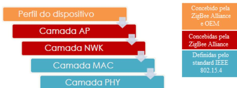
Figura 2.3 Arquitetura de camadas do protocolo Zigbee
