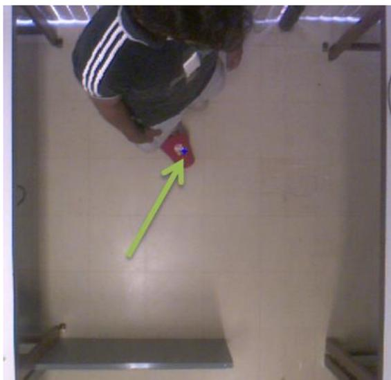
**Figura 4. 12- Coordenada (x,y) representada pelo asterisco azul e referente a identificação do marcador vermelho fixado ao pé do usuário.**
