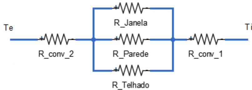
Figura 2.9: Modelo resistivo do sistema.
