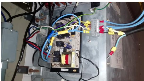
Figura 3.11: Placa de circuitos da evaporadora reconfigurada.
