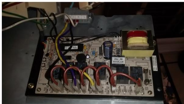
Figura 3.10: Placa de circuitos da evaporadora.
