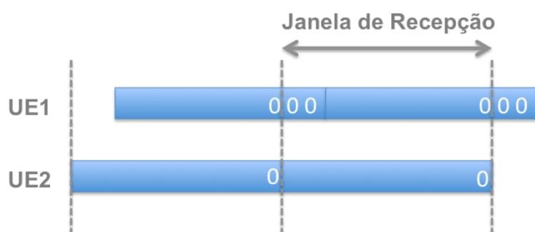
**Figura 13 – Compensação do ZT-DS-OFDM em diferentes atrasos de propagação**
